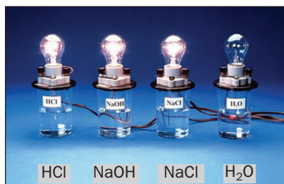
Мал. 26. Виявлення здатності водних розчинів і води проводити електричний струм
