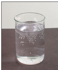
Мал. 18. Виділення пухирців розчиненого повітря із нагрітої водопровідної води
